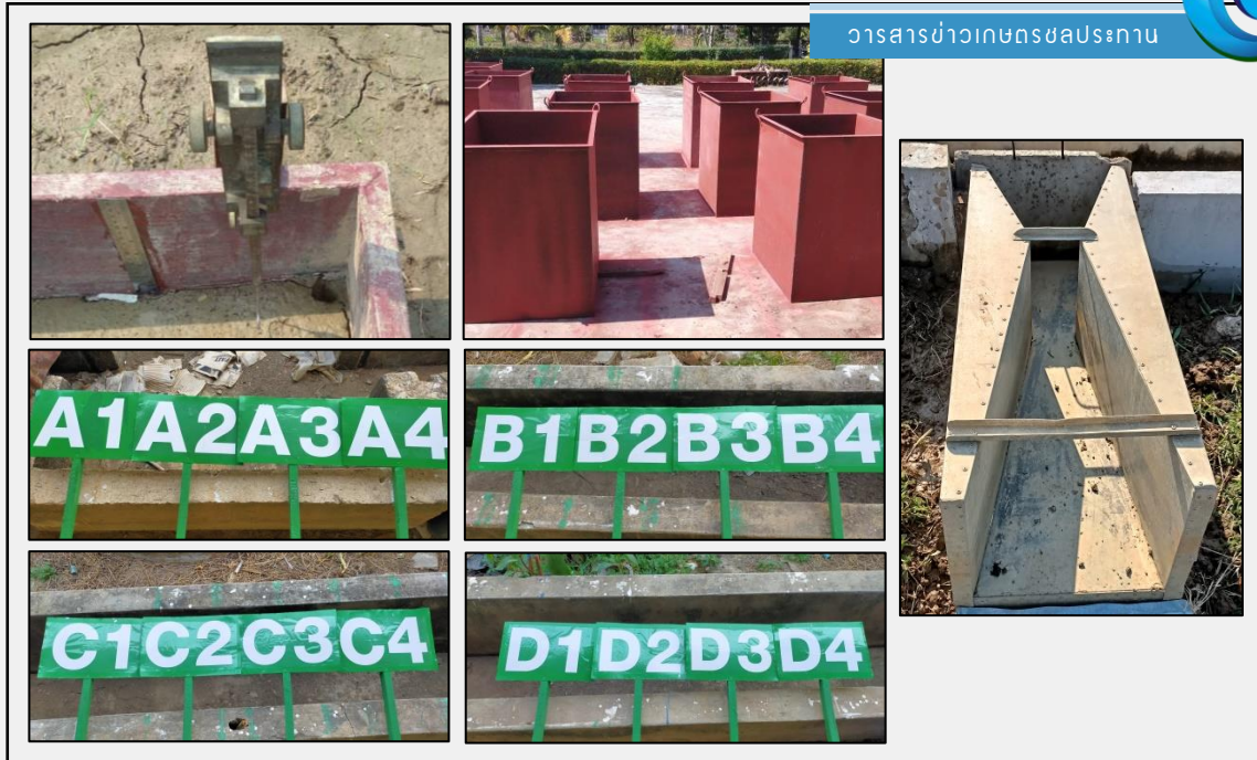
ภาพที่ 2 แสดงอุปกรณ์ที่ใช้ในการศึกษา ได้แก่ ถังไลซิเมตรข้าวแบบกั้นเปิดและกั้นปิด, Hook gauge, Cut Throat Flume ขนาดคอ 10 เซนติเมตร และป้ายแสดงถังไลซิเมตร
