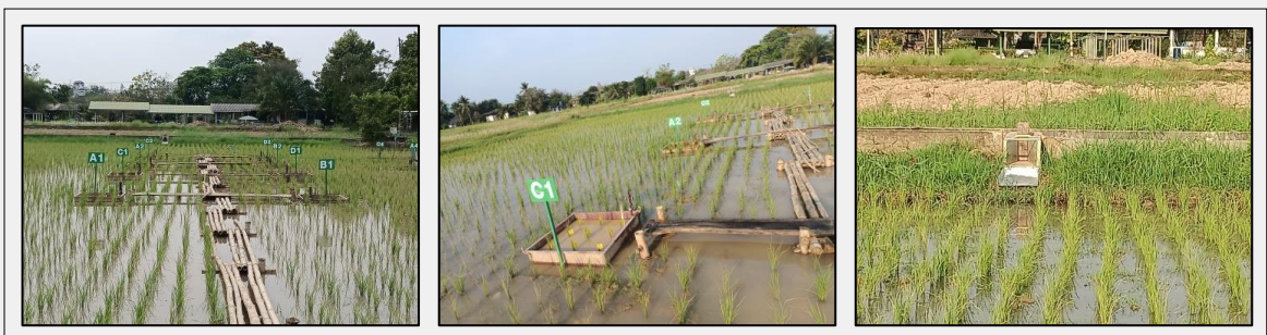
ภาพที่ 5 แสดงการวางถัง, การทำสะพาน, การปลูกข้าวในถังไลซิเมตรและนอกถังและการปักป้ายแสดงถังฯ
