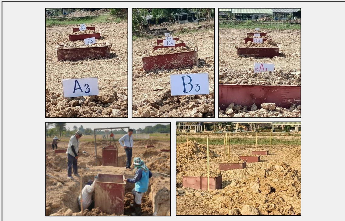
ภาพที่ 3 แสดงการฝังถังไลซิเมตรลงในแปลงนาพื้นที่ศึกษา
