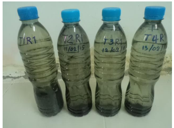
ภาพการเก็บตัวอย่างน้ำสำหรับวิเคราะห์คุณภาพน้ำและตะกอนแขวนลอย
