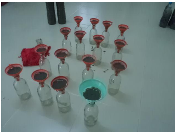
ภาพการวิเคราะห์หาปริมาณตะกอนแขวนลอย และการเก็บข้อมูลการเจริญเติบโตของข้าว
