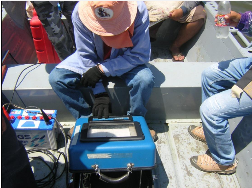
รูปที่ ก-4 การสำรวจความลึกของท้องอ่างเก็บน้ำด้วยเครื่อง Echo Sounder
