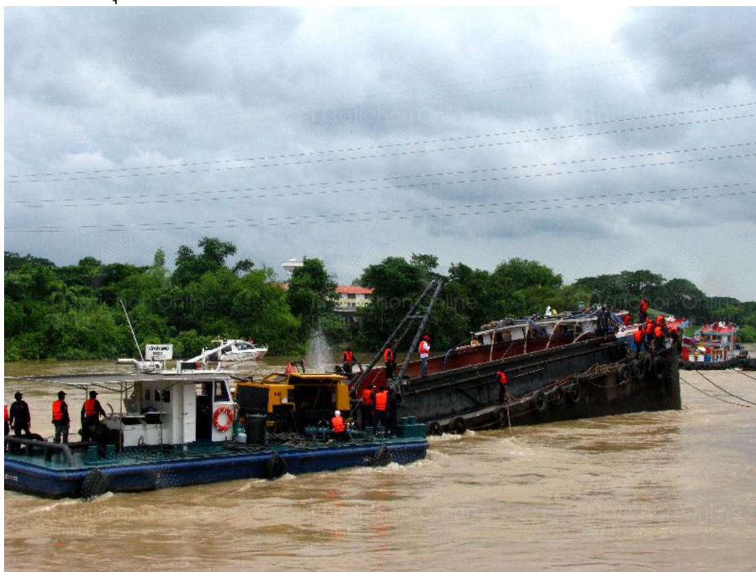
รูปที่ 9 การกู้เรือบรรทุกน้ำตาลล่มเข้าฝั่ง หลังใช้พอนทูนพยุงเรือขึ้นเหนือน้ำ
