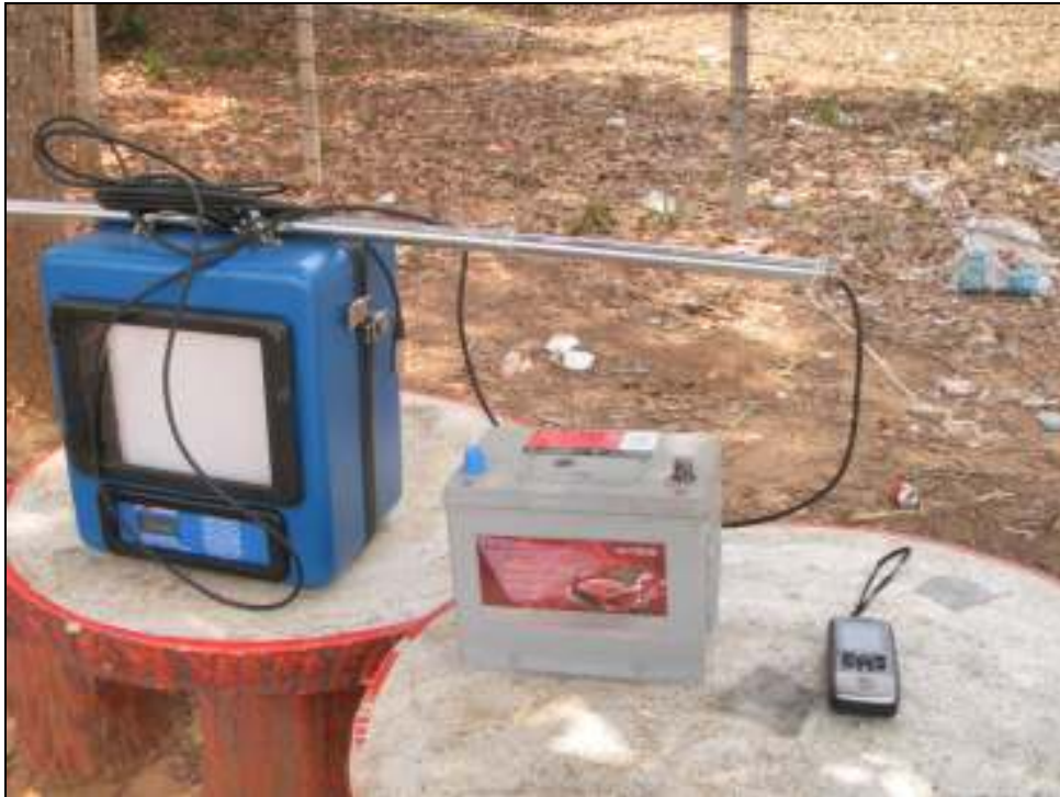
รูปที่ ง-3 เครื่องหยั่งความลึกน้ำโดยใช้เสียงสะท้อน (Echo Sounder)
