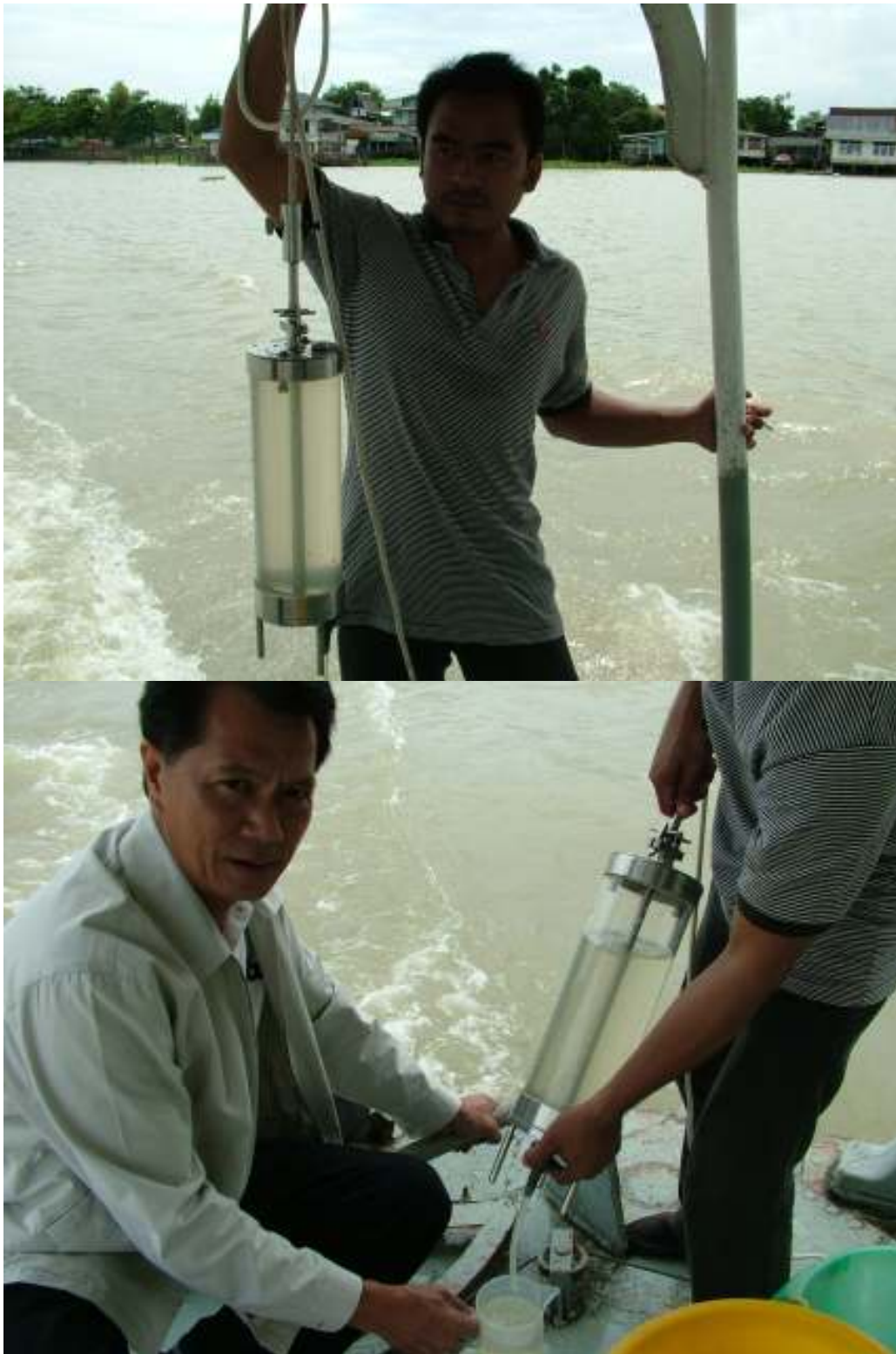
ภาพที่ ง-4 การดักและเก็บตัวอย่างคุณภาพน้ำสำหรับการวิเคราะห์ในห้องปฏิบัติการ
