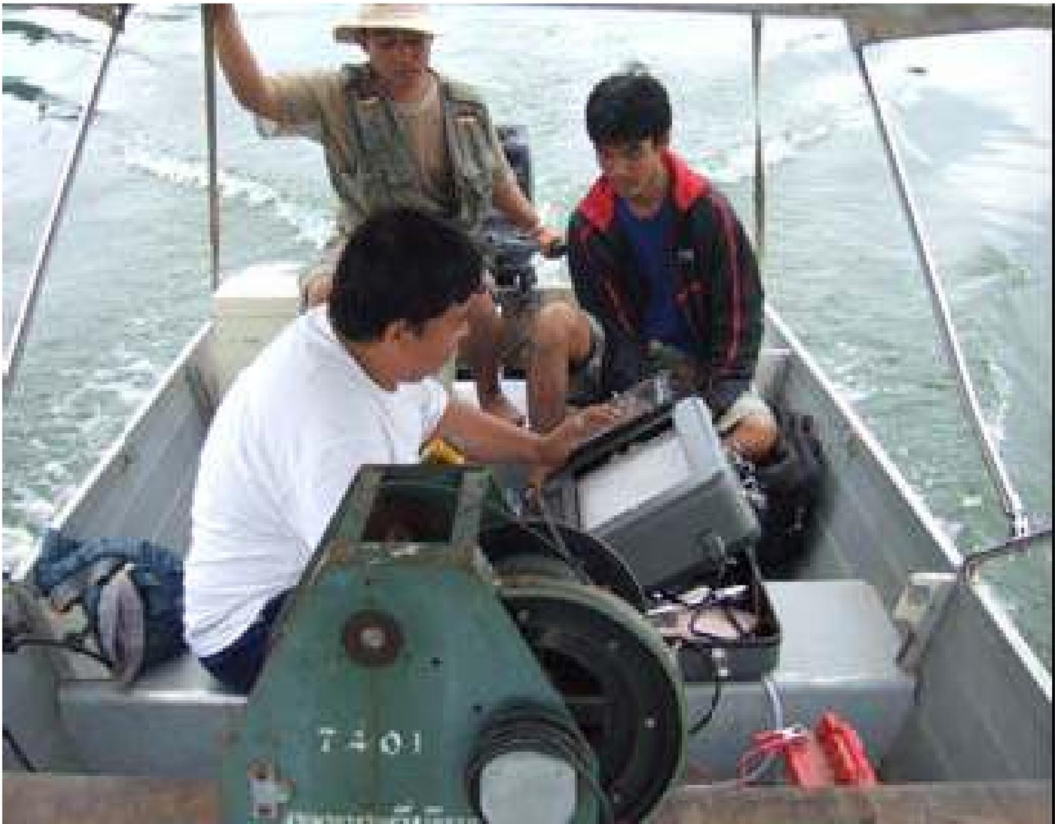
รูปที่ 9 การสำรวจความลึกของอ่างเก็บน้ำโดยเครื่อง Echo Sounder
