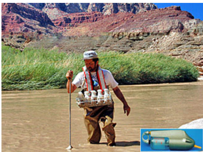
รูปที่ 3.4 การแสดงการเก็บข้อมูลตะกอนใน แม่น้ำโคโลราโด น้อย 1 กิโลเมตรจากต้นแม่น้ำโคโลราโด แกรนด์แคนยอน รัฐอริโซนา สหรัฐอเมริกา Credit: USGS
