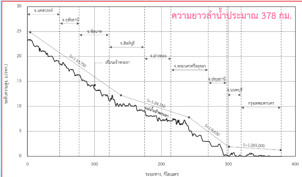
รูปตัดตามยาวแม่น้ำเจ้าพระยาแสดงความลาดชันของลุ่มน้ำ
