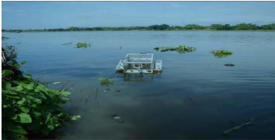
รูปที่ 10 แพสำหรับสูบน้ำเข้าเครื่องตรวจวัดคุณภาพน้ำ ( กรมควบคุมมลพิษ )
