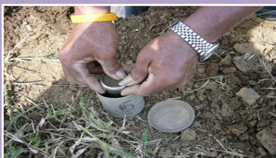
7. ดันดินใส่กระป๋องเก็บตัวอย่างดิน แล้วนำไปอบแห้ง
