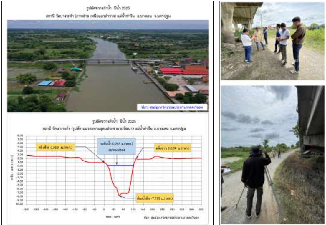
รูปที่ ๘ สำรวจรูปตัดขวางลำน้ำ บริเวณสะพานอุทมประชาชนาพัฒนา
