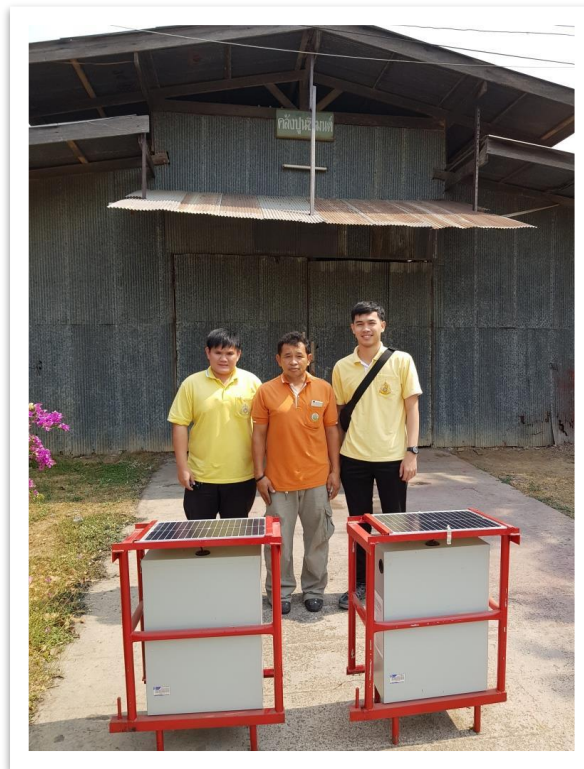
รูปที่ 1 การจัดหาอุปกรณ์สถานีโทรมาตรในภาคสนามที่ใช้พลังงานแสงอาทิตย์
