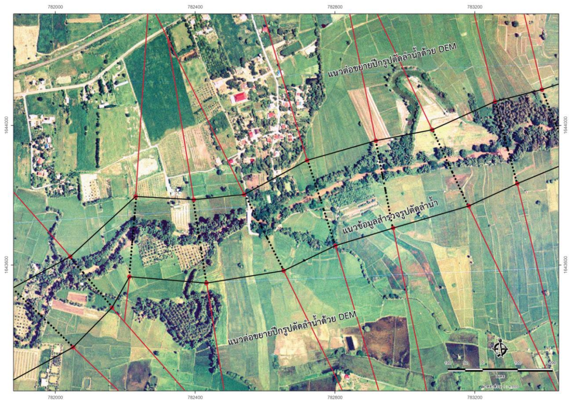
รูปที่ 3 - 10 การต่อขยายปีกรูปตัดขวางลำน้ำด้วยข้อมูล DEM เพื่อคำนวณแผนที่น้ำท่วม
