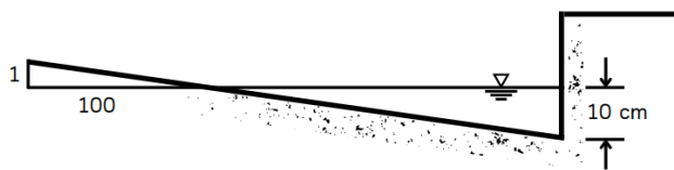
ภาพที่ 2 : รางระบายน้ำคอนกรีตข้างถนน
