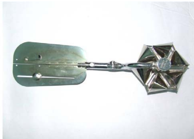
รูปเครื่องวัดกระแสน้ำ (Current Meter)แบบถ่วง (PYGMEE) ใช้กับกระแสน้ำที่มีความเร็วไม่สูง
