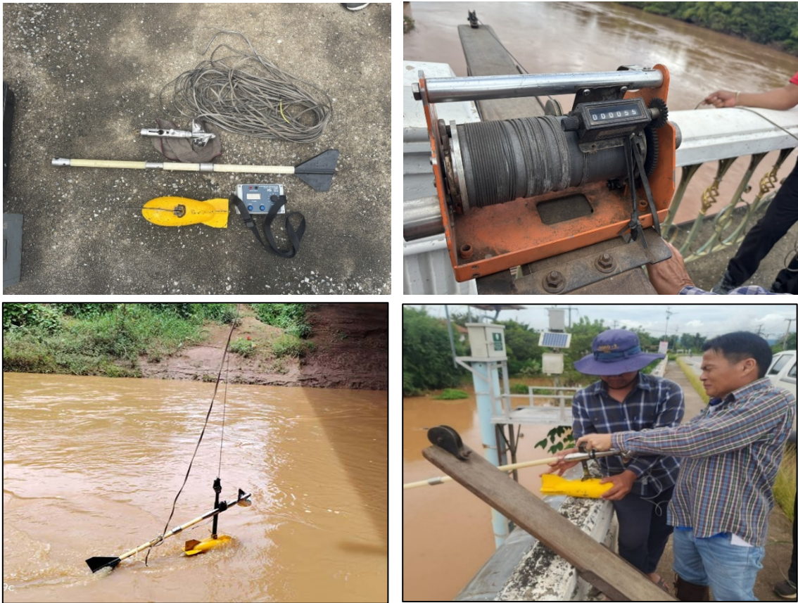
รูปที่ 8 ตัวอย่างการสำรวจปริมาณน้ำด้วยเครื่องมือ Current Meter
