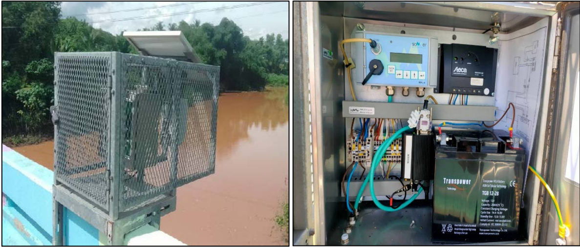
รูปที่ 4 ตัวอย่างเครื่องมือวัดระดับน้ำแบบ Radar
