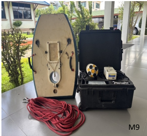
รูปที่ 9 ตัวอย่างเครื่องสำรวจปริมาณน้ำแบบ ADCP
