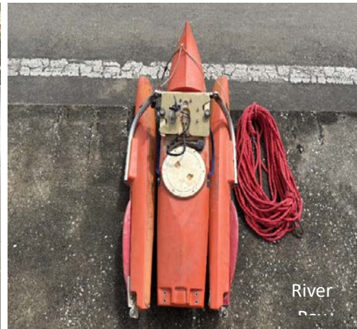
รูปที่ 9 ตัวอย่างเครื่องสำรวจปริมาณน้ำแบบ ADCP
